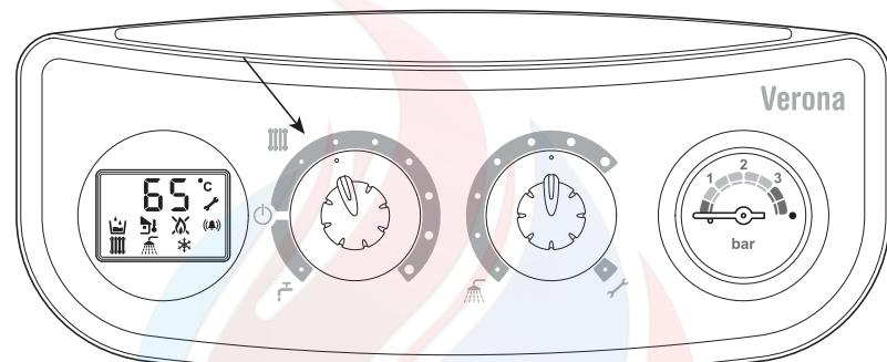
۳- دسته تنظیم دمای آب گرم مصرفی: برای تنظیم درجه حرارت آب گرم مصرفی به کار می‌رود. با چرخاندن دسته تنظیم در جهت حرکت عقربه‌های ساعت، دمای آب گرم مصرفی افزایش و با چرخاندن آن در خلاف جهت حرکت عقربه‌های ساعت، دمای آب کاهش می‌یابد.
